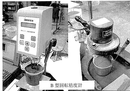
写真 - 4 回転粘度計による粘度測定試験の概要
