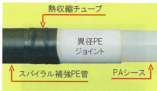
写真 - 3 PA シースとスパイラル補強 PE 管の接合状況
