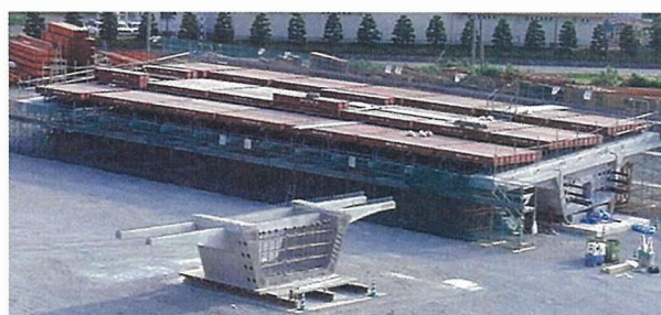
写真-3 実物大モデルによるねじり挙動実験
