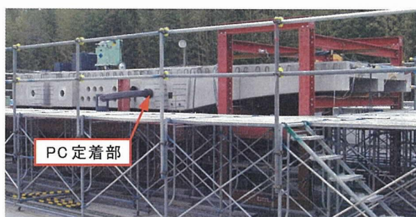
写真-4 実物大モデルによるPC定着部付近の確認実験
