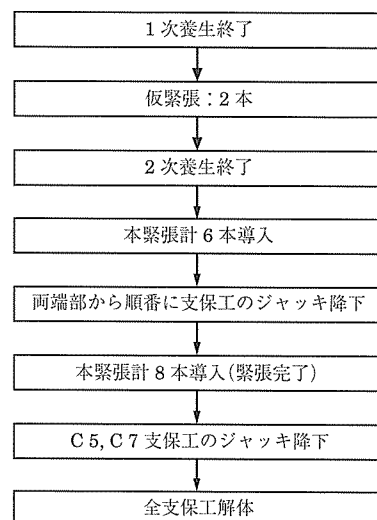
図-9 養生、緊張、支保工解体順序
