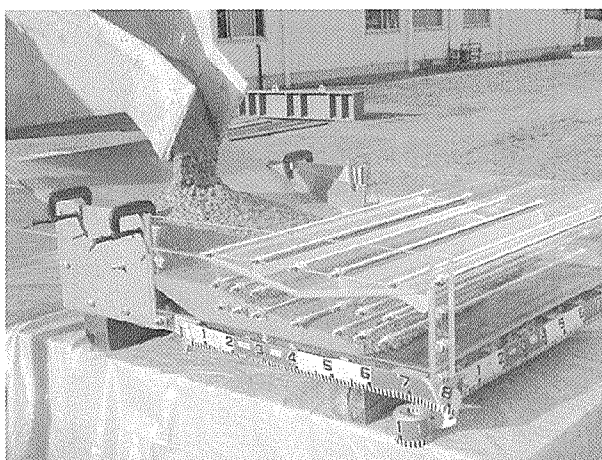
写真 - 1 模擬試験体 A を用いた高流動コンクリートの充てん性確認実験
