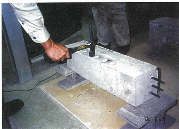
写真 - 5 打撃試験状況
