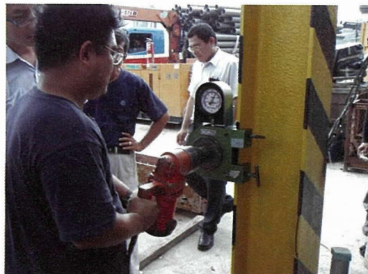
写真 - 10 締付け試験状況
