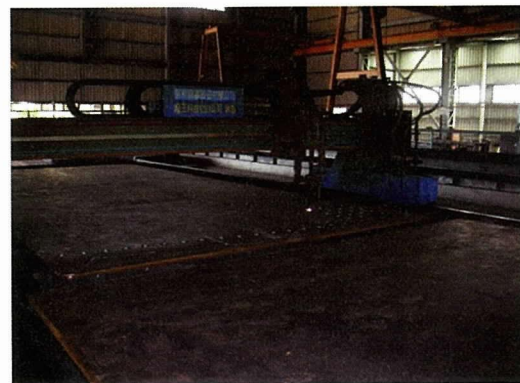
写真 - 6 鋼板切断状況
