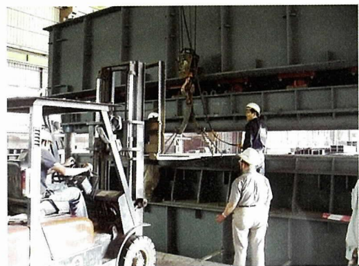
写真 - 5 波形鋼板ウェブ試験製作
