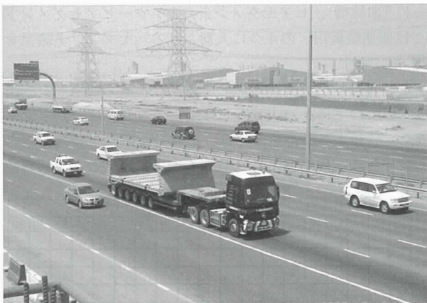
写真 - 3 セグメント運搬状況
