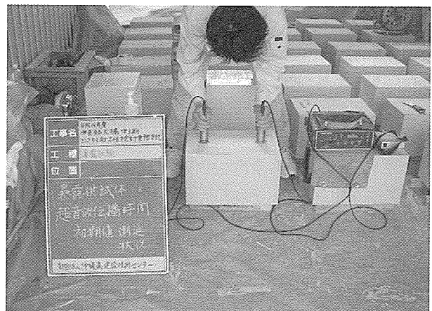
写真 - 14 超音波伝播速度の初期値計測状況
