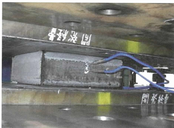
写真-3 熱電対埋込み試験状況
