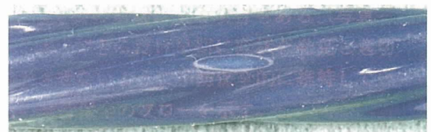
写真-5 ECF ストランドでのフレット疲労試験による素線破断の状況 (PC鋼材の露出、破断は生じていない)
