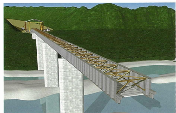
図 - 10 波形鋼板を先行押し出し架設する工法の概要図
