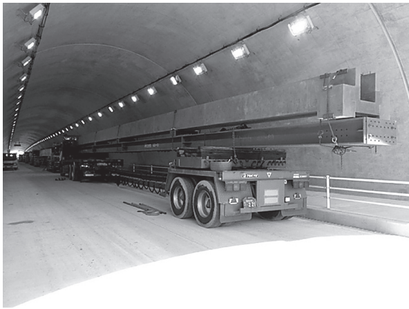
写真 - 5 UFC 桁の運搬荷姿
