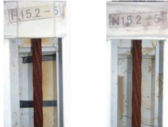
(b) 高強度 PC 鋼より線 15.2 mm (c) JIS SWPR7BL 15.2 mm
