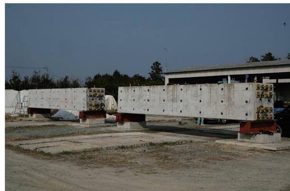
写真 - 2 ASR 劣化試験体
