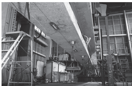
写真-2 AE センサーを用いたモニタリング
