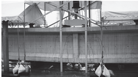
写真 - 3 実物大 PC 鉄道橋模型の載荷実験状況
