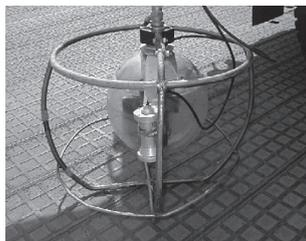
写真 - 8 遠隔操作型水中カメラ
