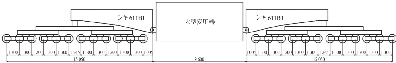
図 - 3 シキ車 (大型変圧器積載) 概要図
