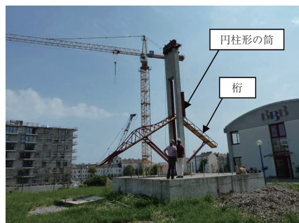
写真 - 2 桁部分が開閉途中の状況（大学実験場）
