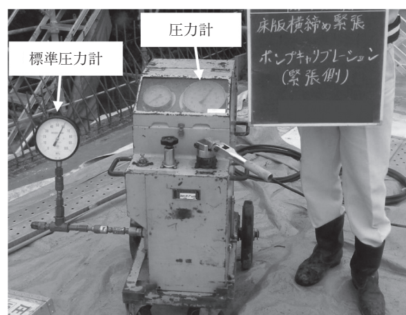
写真 - 2 圧力計のキャリブレーション
