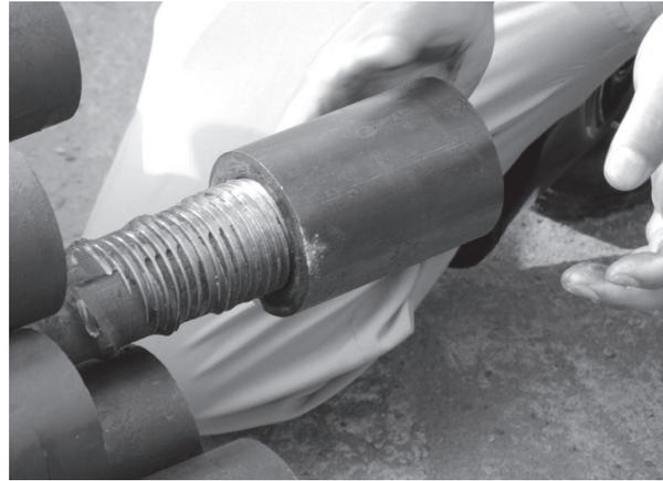
写真 - 6 現場加工の機械式継手
