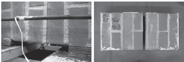
写真 - 9 試験体破壊状況 (BM-3 No.3)
