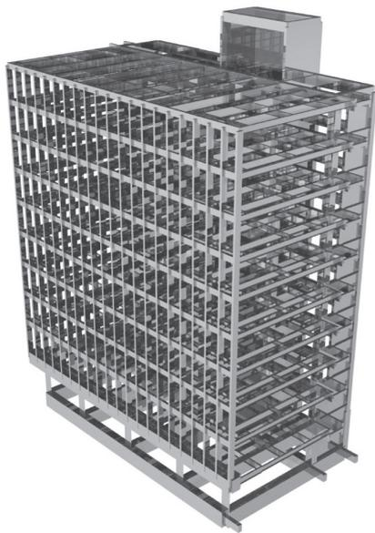
図 - 4 構造解析モデル
