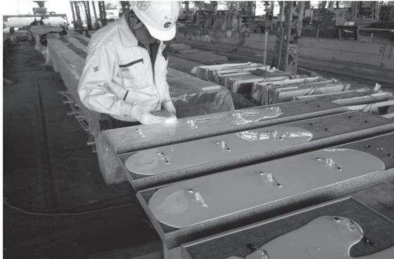
写真 - 1 石材裏面処理
