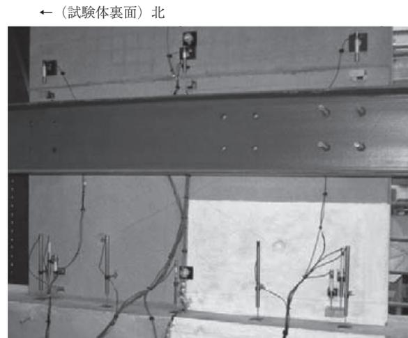
図-3 変位計による計測
