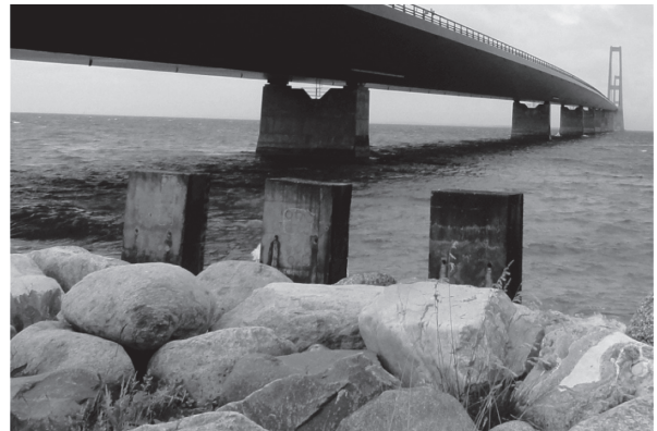
写真 - 16 暴露供試体
