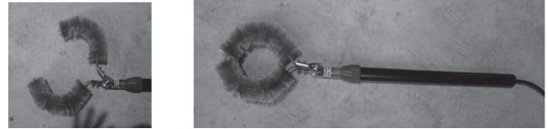
写真 - 3 ピンホールテスター
