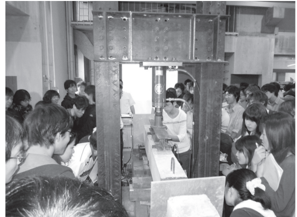
写真 - 2 PC 梁荷重実験風景
