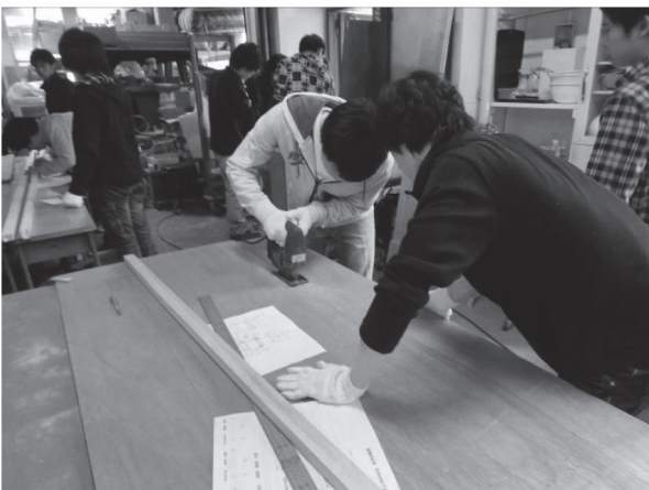
写真 - 3 コンクリート供試体の型枠製作 (3年生)
