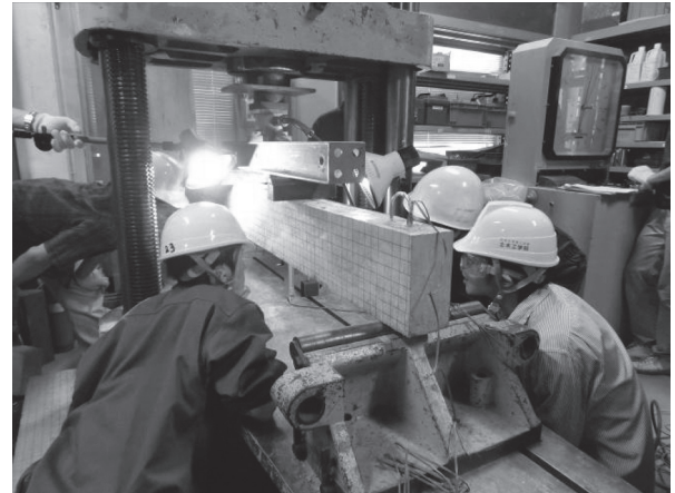
写真 - 4 曲げ破壊実験 (3年生)
