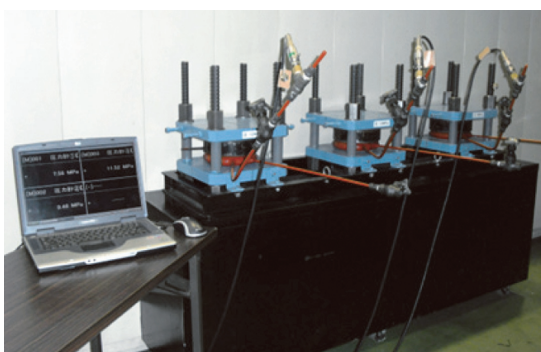
写真 - 2 揚力保持試験状況
