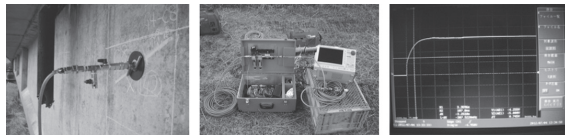
写真 - 7 空圧法 調査状況・機器および出力波形例
