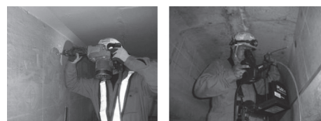
写真 - 5 削孔・CCD 法 調査状況
