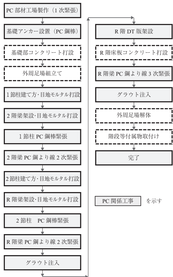
図 - 6 施工フローチャート
