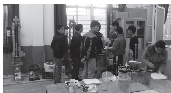
写真 - 4 供与された機材による実験の様子 (窓際の機材はアスファルト用のマーシャル試験機)
