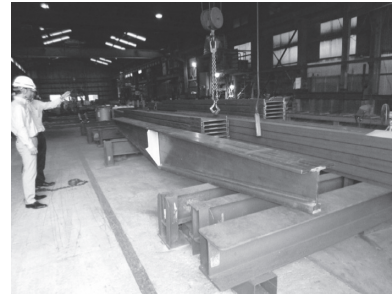
写真 - 9 BH 部材モックアップの製作
