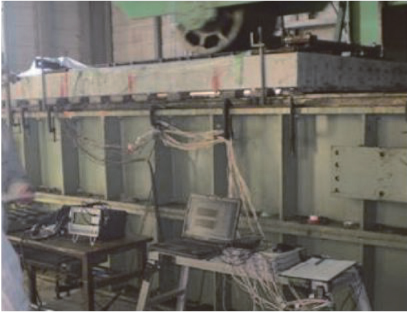
図 - 3 繰返し輪荷重走行試験
