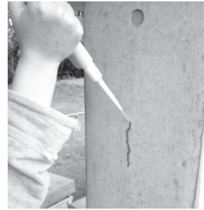
図 - 5 流水試験の様子 22) と原理
