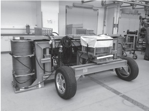
写真 - 13 MFL 装置の磁場発生装置
