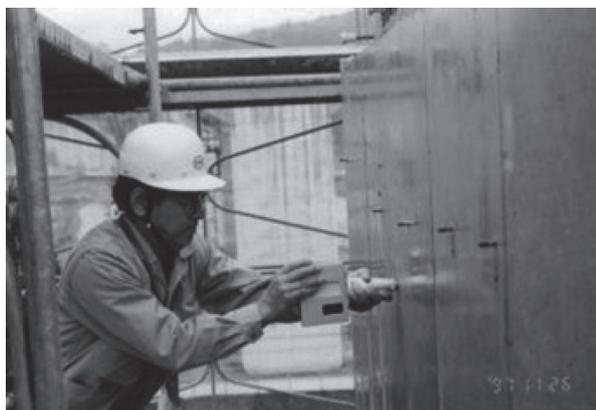
写真 - 1 反発硬度法による検査状況
