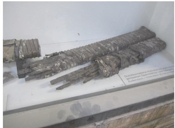
写真 - 12 崩落した PC 構造の PC 鋼材破断状況 (BAM 保管)
