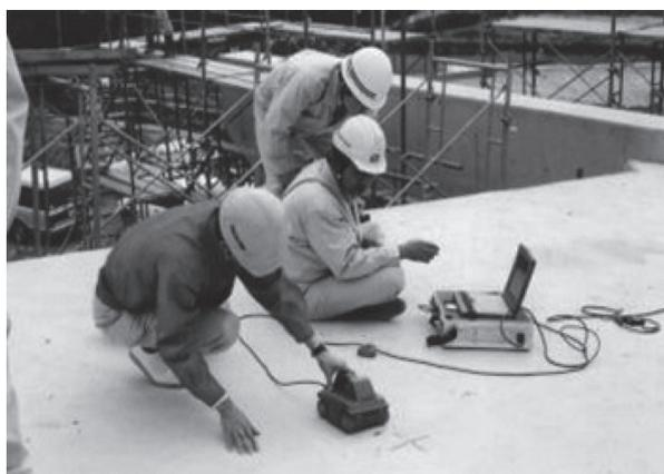
写真 - 2 電磁波法によるかぶり検査状況
