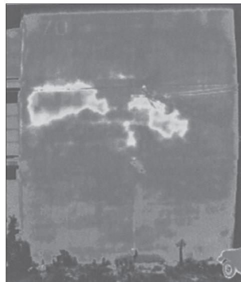
写真 - 8 コンクリートの浮きの調査事例
