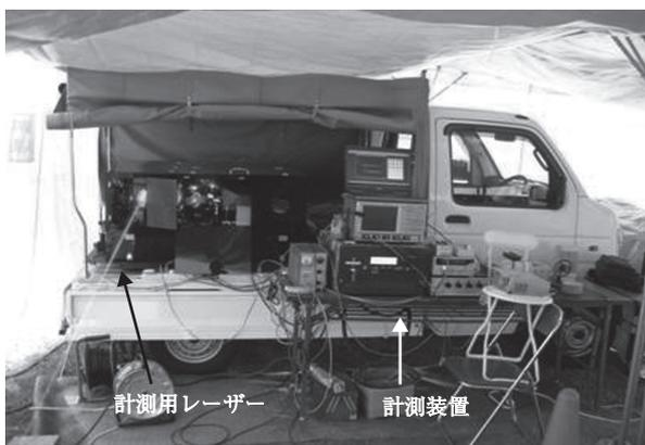
図 - 4 レーザーリモートセンシング法による試作1号機
