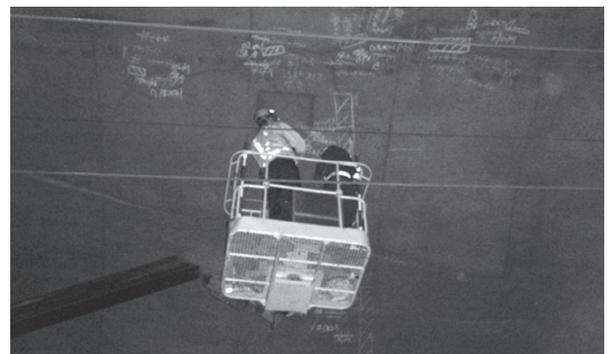
写真 - 3 打音による加速度計計測試験状況
