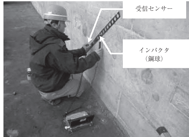
写真 - 3 衝撃弾性波による測定状況 1)
