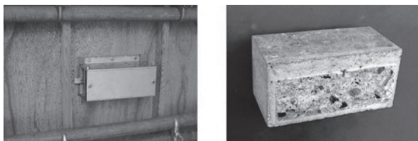
ボス型枠設置状況 取り出した試験体
