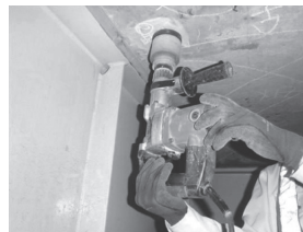
写真 - 1 鉄筋露出状況 写真 - 2 塩化物イオン濃度測定 の粉末採取
