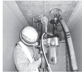
写真 - 3 小径コアによる圧縮強度試験
