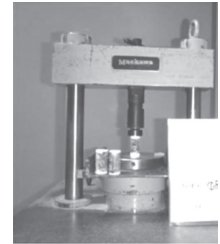
写真 - 3 小径コアによる圧縮強度試験
