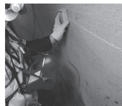
写真 - 4 電磁誘導法(事例) 写真 - 5 中性化深さ試験
