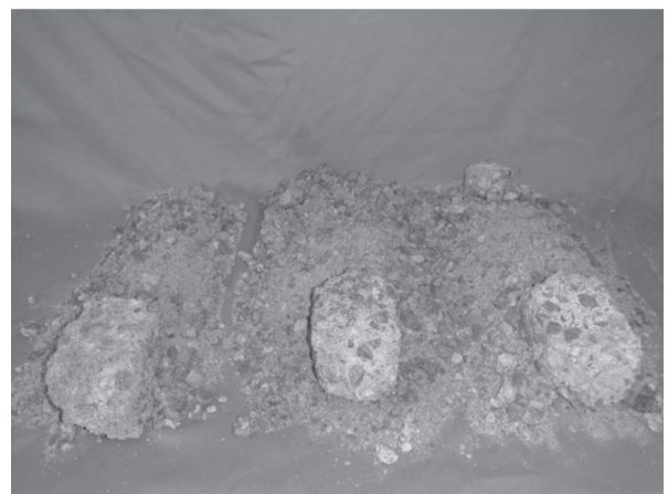
写真 - 5 凍結融解試験結果 (上：標準的な PC 仕様、下：対象橋仕様)
