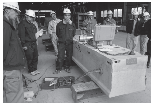
写真 - 2 透気試験 (Torrent 法) の状況
