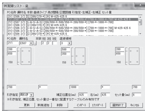
図 - 4 PC 鋼材配線の入力画面例
