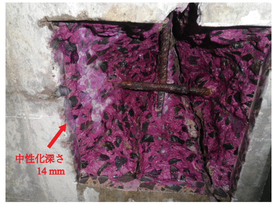
写真 - 3 はつり調査および中性化深さ調査結果
