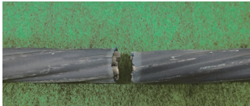
(b) 引張破断試験後の鋼材外観
