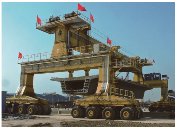
図 - 7 64 輪タイヤ式門型クレーンによる 9 000 kN 複線用箱桁の輸送 (写真提供: BWM)
