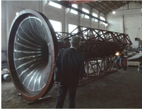
写真 - 16 柱の型枠
