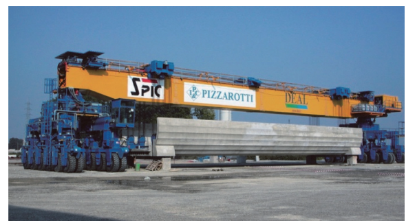
図 - 14 ビボットトラクター付き 31.5 m - 単線 U 桁用の門型輸送機 (58 m, 3200 kN)
