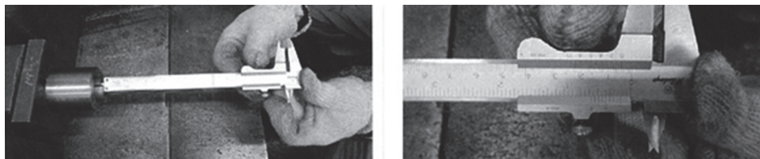
写真 - 3 くさび段差の測定
