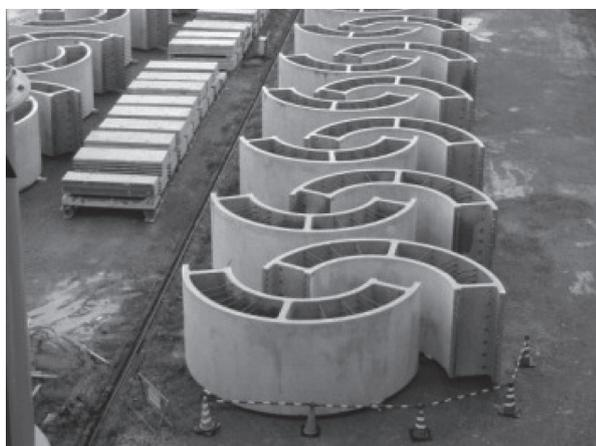
写真 - 3 ハーフプレキャスト部材 ( $\sigma_{ck} = 50 \text{ N/mm}^2$ )
